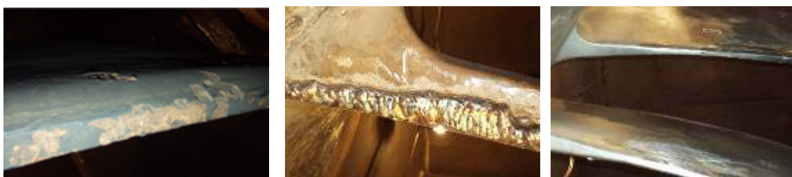
Fig. 1: Da esquerda para a direita: Pá de rotor da turbina hidroelétrica danificada pela erosão por cavitação. Recuperação da pá através da solda de reparo. Peça após o reparo e tratamento por shot peening. Foto: Tetyana Gurova
