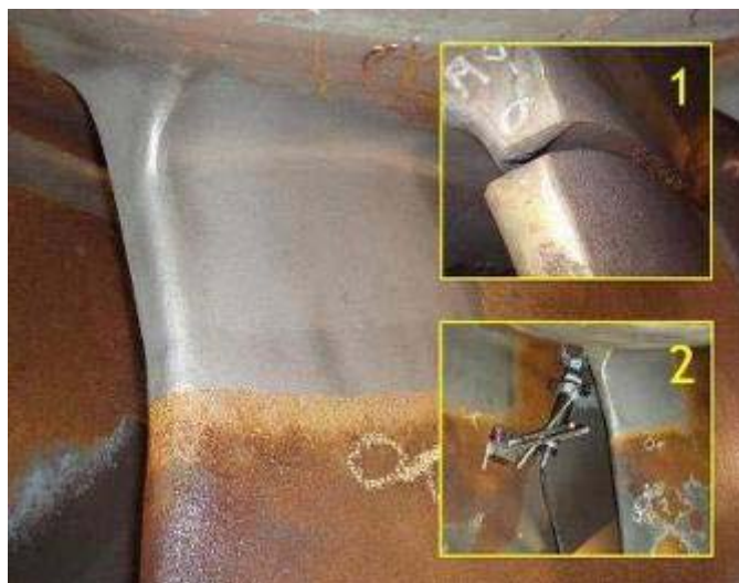
Fig. 2: Procedimento de solda de reparo aplicado para recuperação da pá de uma turbina hidroelétrica com trinca ao lado da coroa. Medição das tensões utilizando equipamento portátil de difração de raios-X RAYSTRESS para avaliação da eficiência do tratamento por shot peening. Foto: Tetyana Gurova
