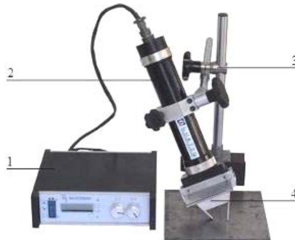
Fig. 4: RAYSTRESS: Equipamento portátil de raios-X para medição de tensões mecânicas: 1 – unidade de controle com fonte de alta tensão; 2 – fonte de alta tensão e tubo de raios-X; 3 – suporte magnético; 4 – colimador com cassete para filme de raios-X
