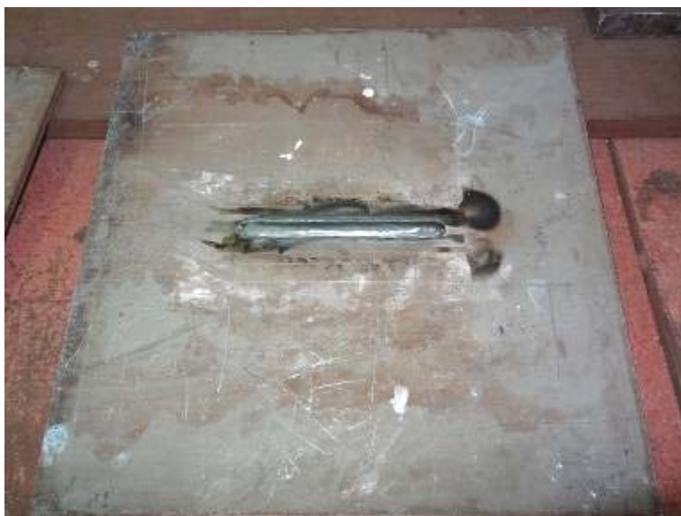
Fig. 3: Corpo de prova com solda de reparo
