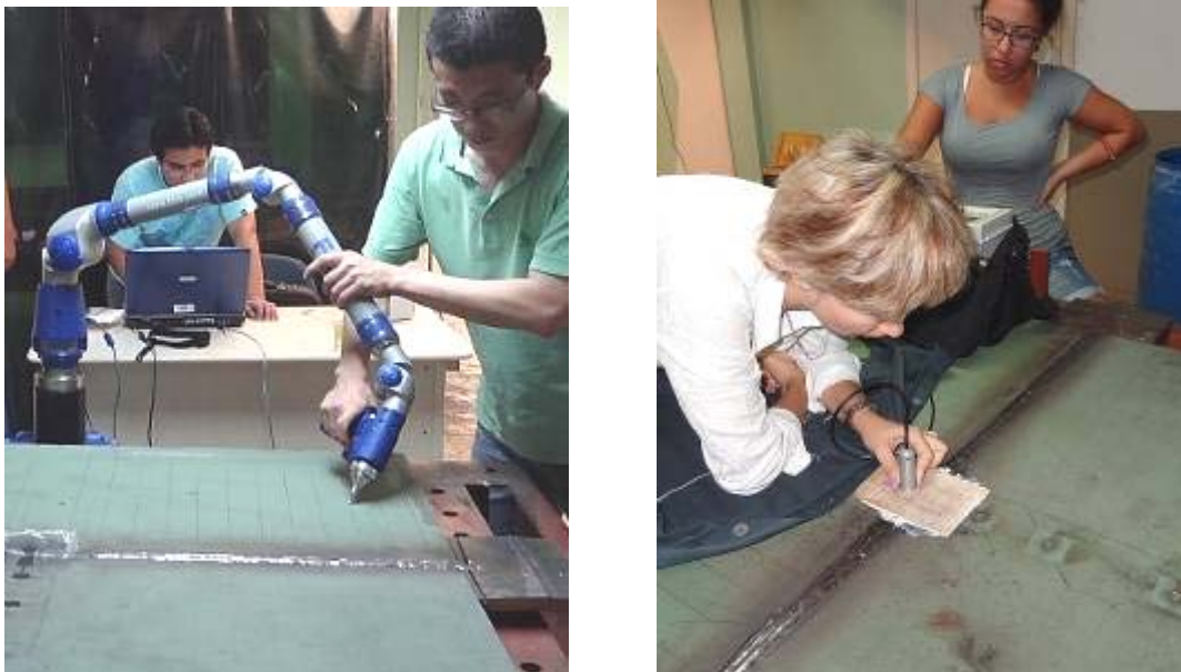
Fig. 2: Medição dos deslocamentos verticais da superfície das chapas soldadas com equipamento FARO ARM (a esquerda) e mapeamento das tensões residuais com equipamento magnético (a direita)
