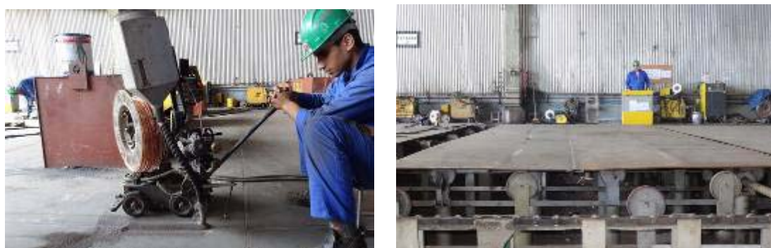
Fig. 1: Processo de soldagem das chapas navais (à esquerda) e painéis navais soldados na linha de produção (à direita). Foto: Tetyana Gurova
