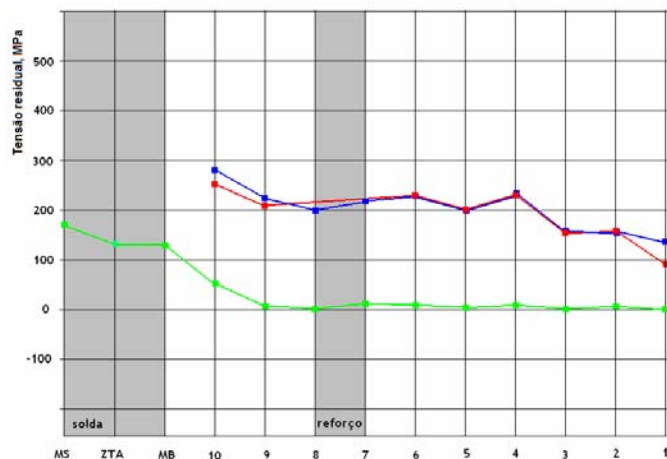
Fig. 12: Arame simples. Tensões residuais transversais: cor vermelha – todas as restrições impostas; cor azul – somente restrições laterais impostas; cor verde – livre das restrições
