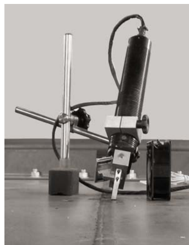
Fig. 3: Equipamento portátil RAYSTRESS® em posição de trabalho
