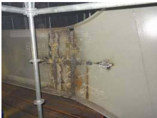
Fig. 1: Solda de reparo nos elementos do bloco de navio realizada durante sua montagem. (Foto: Tetiana Gurova)
