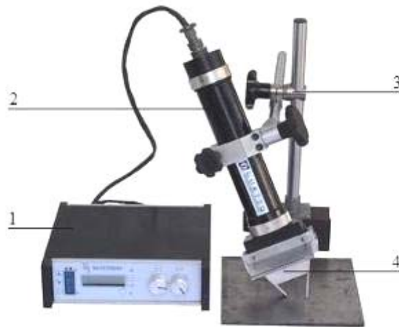
Fig. 9: RAYSTRESS: Equipamento portátil de raios-X para medição de tensões mecânicas: 1 – unidade de controle com fonte de alta tensão; 2 – fonte de alta tensão e tubo de raios-X; 3 – suporte magnético; 4 – colimador com cassete para filme de raios-X
