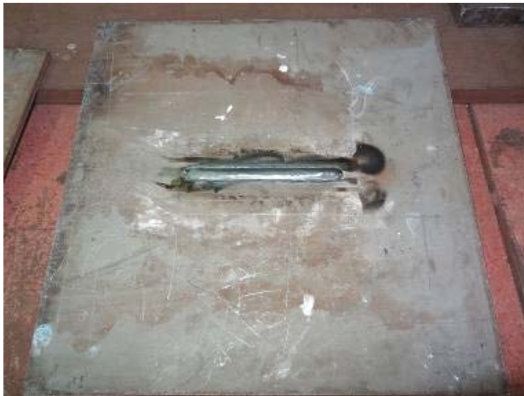
Fig. 8: Corpo de prova com solda de reparo
